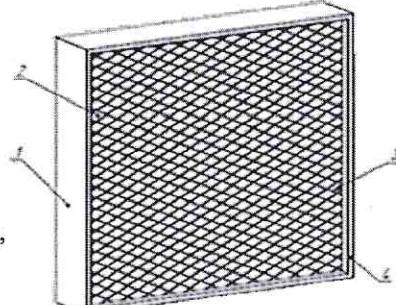
По требованию заказчика, может устанавливаться одна защитная сетка, со стороны выхода или входа воздушного потока, или не устанавливаться совсем. Для герметизации фильтра в вентиляционном оборудовании используется гелевый, бесшовный полиуретановый или EPDM уплотнитель (4).
